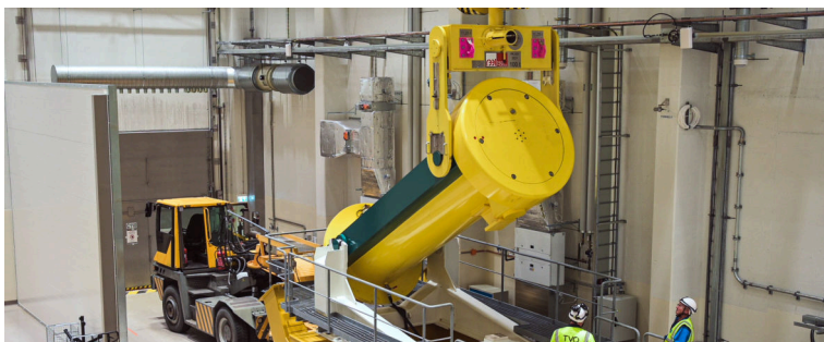
RYS. 8.11 Testowy pojemnik transferowy wypalonego paliwa w zakładzie hermetyzacji Posivy w Olkiluoto podczas próby procesu składowania w 2024 r. Próba została przeprowadzona bez materiału promieniotwórczego.
