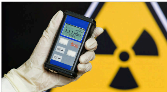
RYS. 7.9 Każdy pracownik nosi własny dozymetr – jego dawka jest dokładnie mierzona, a nie szacowana.
