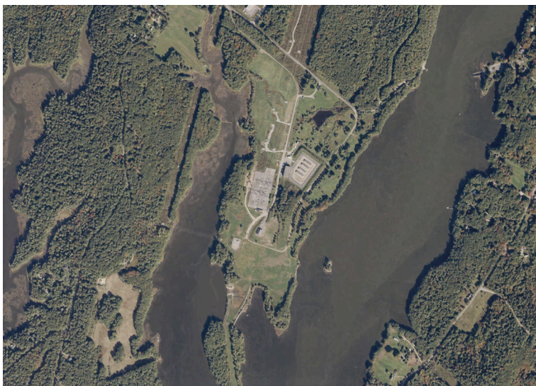
RYŚ. 10.9 Teren dawnej Elektrowni Jądrowej Maine Yankee w Wiscasset po zakończeniu likwidacji. Zabudowania elektrowni usunięto; na półwyspie pozostały stacja elektroenergetyczna i suchy magazyn wypalonego paliwa. Zobrazowanie lotnicze z 6 października 2021 r.
