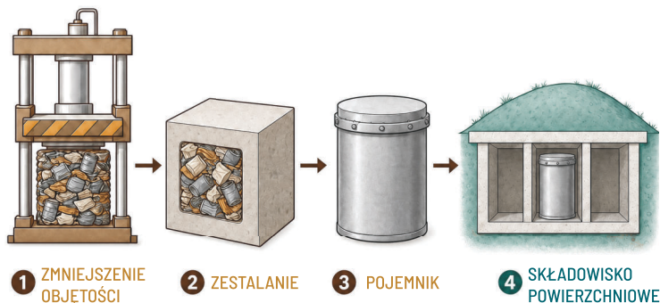
RYŚ. 8.2 Odpady nisko- i średnioaktywne zmniejsza się objętościowo, zestala, pakuje w pojemniki i składowe na powierzchni.
