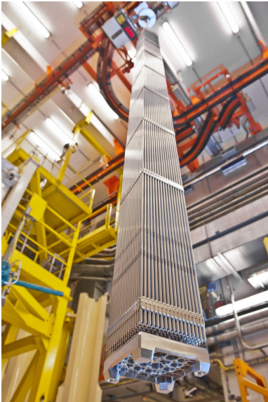
Rysunek 1: Kaseta paliwowa typowego reaktora jądrowego, źródło: World Nuclear Association
