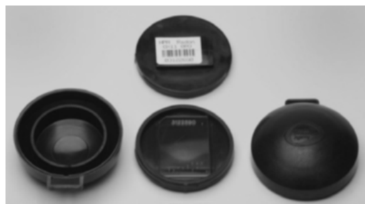
RYS. B KOMORA DYFUZYJNA Z UMIESZCZONĄ PŁYTKĄ CR-39
