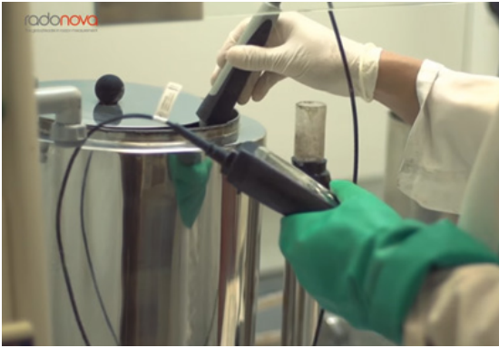
RYS. C PO LEWEJ: PRZYGOTOWANIE ROZTWORU DO WYTRAWIANIA PŁYTEK CR-39 UWIDACZNIĄCEGO ŚLADY CZĄSTEK ALFA, PO PRAWEJ: WYJMOVANIE WYTRAWIONYCH PŁYTEK Z ROZTWORU
