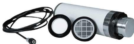
PRZYKŁADOWY DETEKTOR SCYNTYLACYJNY Z FOTOPOWIELACZEM (TYP SSU-3)
