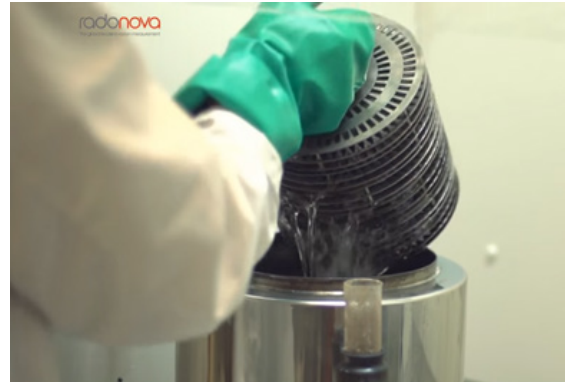
RYS. C PO LEWEJ: PRZYGOTOWANIE ROZTWORU DO WYTRAWIANIA PŁYTEK CR-39 UWIDACZNIĄCEGO ŚLADY CZĄSTEK ALFA, PO PRAWEJ: WYJMOVANIE WYTRAWIONYCH PŁYTEK Z ROZTWORU
